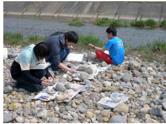
第3図 2014年4月26日の調査風景。左の写真は川の流に垂直方向に線方式調査を行っているようす。右の写真は、調査対象試料の礫径の測定や岩石判定を行っているようす。
