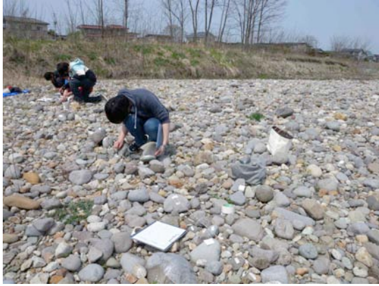
第3図 2014年4月26日の調査風景。左の写真は川の流に垂直方向に線方式調査を行っているようす。右の写真は、調査対象試料の礫径の測定や岩石判定を行っているようす。
